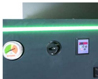
CONTROL AUTOAJUSTABLE DEL CAUDAL DE AIRE REQUERIDO, MEDIANTE INVERTER
