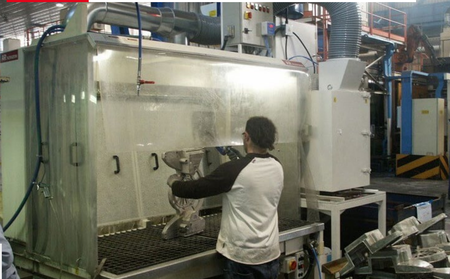
HYDROFILTER e HYDRODESK PARA LOS PROCESOS DE DESBARBADO MANUAL DE MAGNESIO
