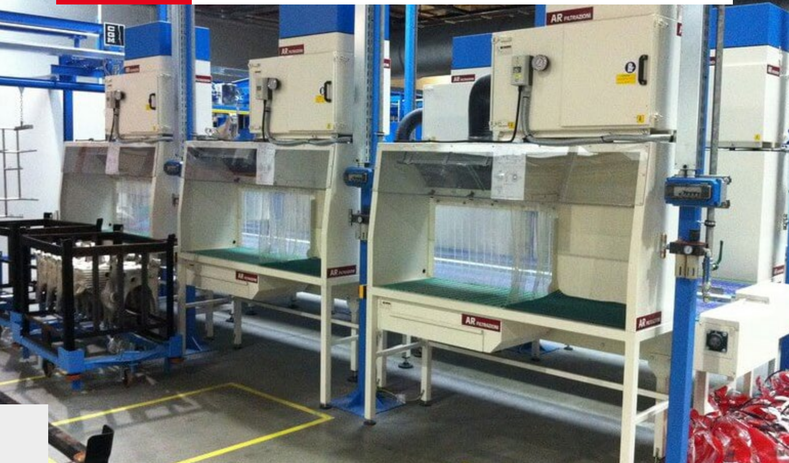
BANCOS DE ASPIRACIÓN ESPECIALES, HECHOS A MEDIDA SEGÚN LAS ESPECIFICACIONES DEL CLIENTE
